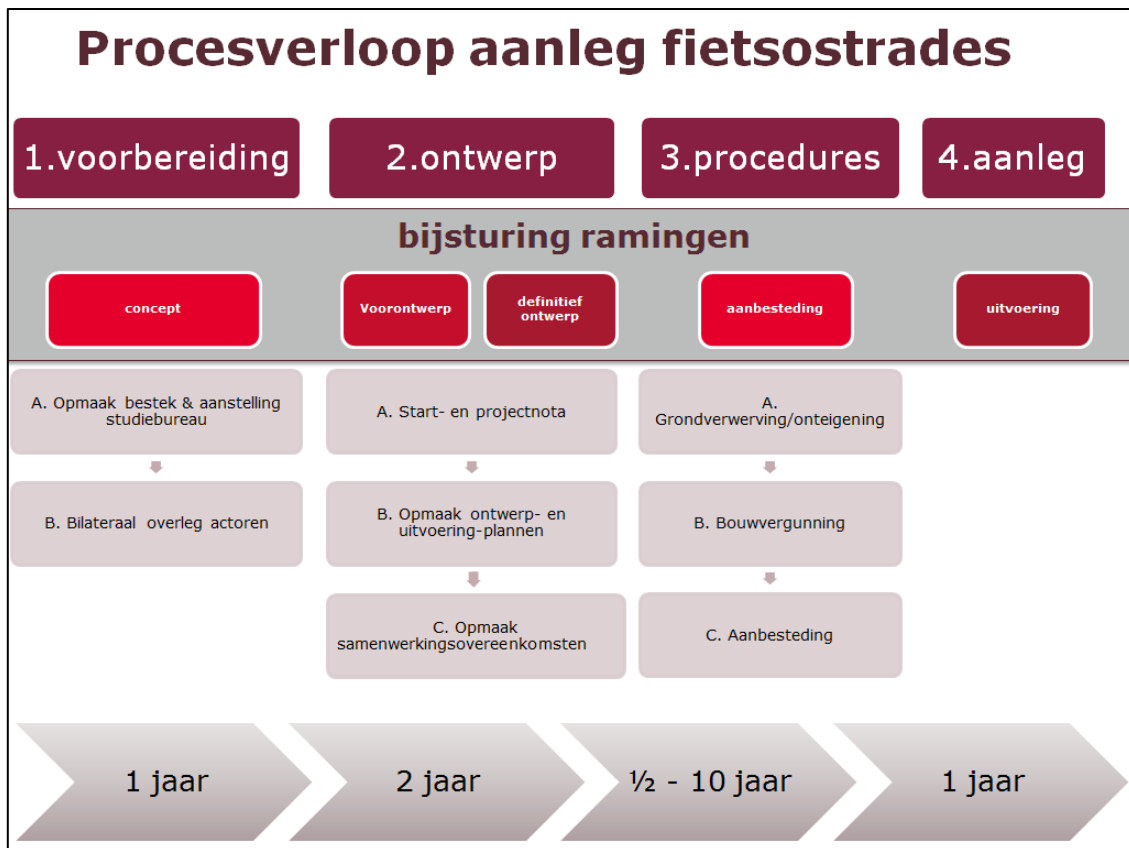
Figuur 4: schema voor het procesverloop van de aanleg van fietssnelwegen in provincie Antwerpen
