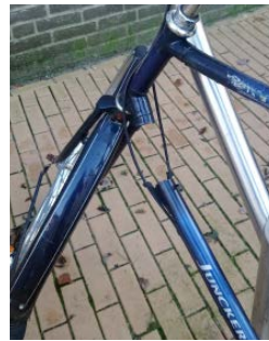
Voorbeeld van gebroken frame.
