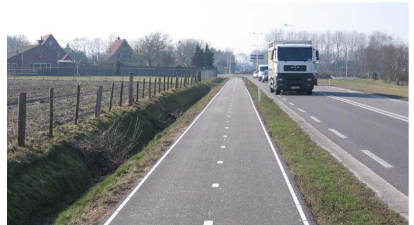
Voorbeeld van 'good practice' van kantmarkering van een tweerichtingen fietspad in de provincie Gelderland. Hier ontbreken nog de langere strepen (1:1) van de asmarkering die in deze brochure worden aanbevolen.
