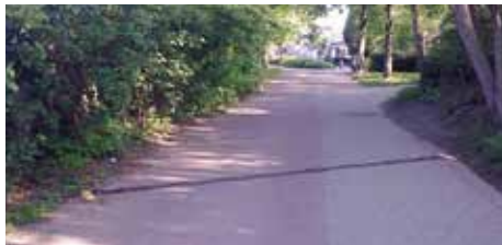
Pneumatische telslang. Foto Flow NV België
