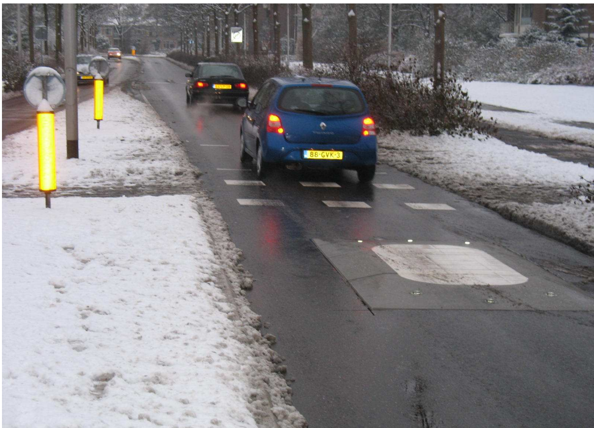
Rechte drempels met als extra aanduiding bolle uitstekende reflectoren. 50 km/u toegestaan.
