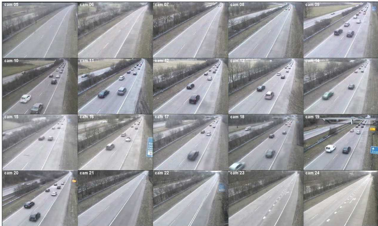
Figuur 2: Videowall van de 20 camera's voor het Video-Based Monitoring meetsysteem
